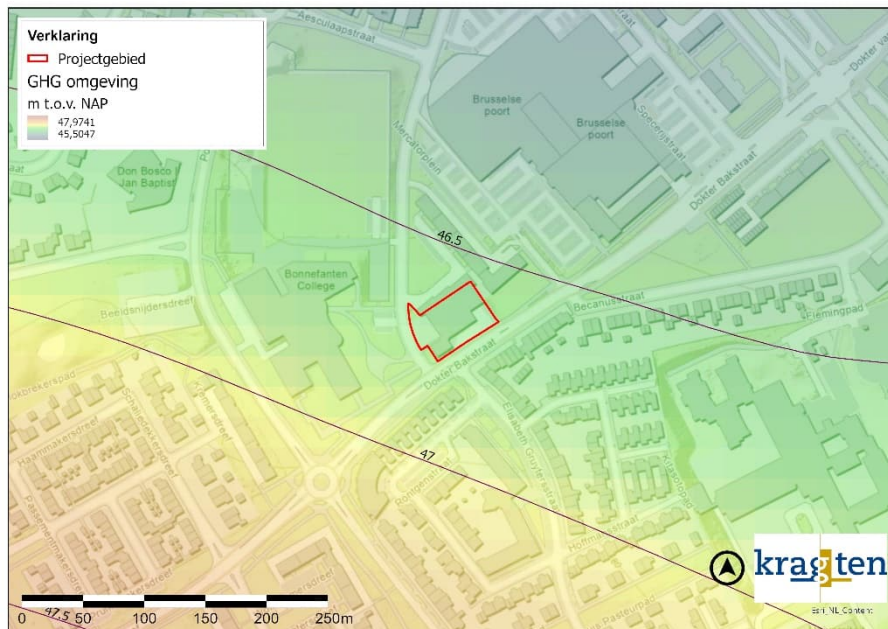
Figuur 9 Resultaten GHG grondwatermodel IBRAHYM
