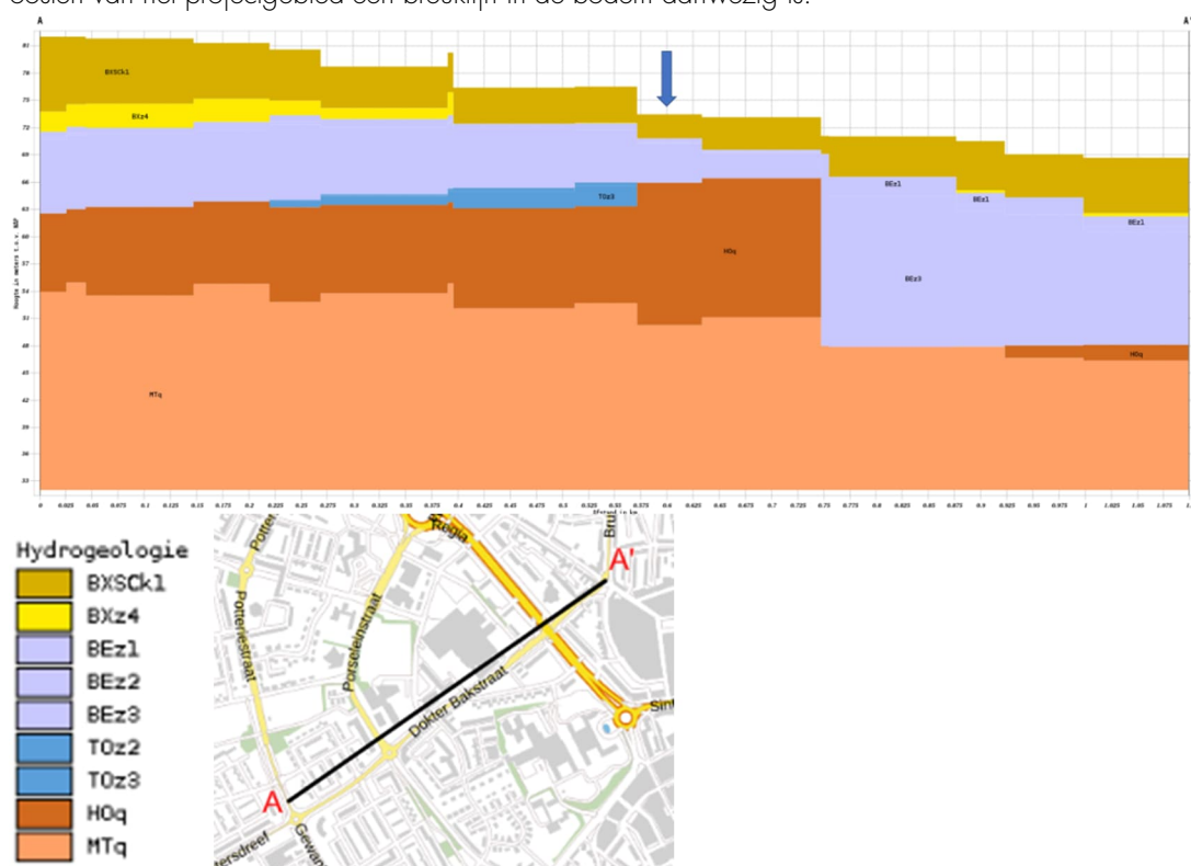
Figuur 5 Geohydrologische doorsnede met de globale locatie van het projectgebied bij de blauwe peil.
